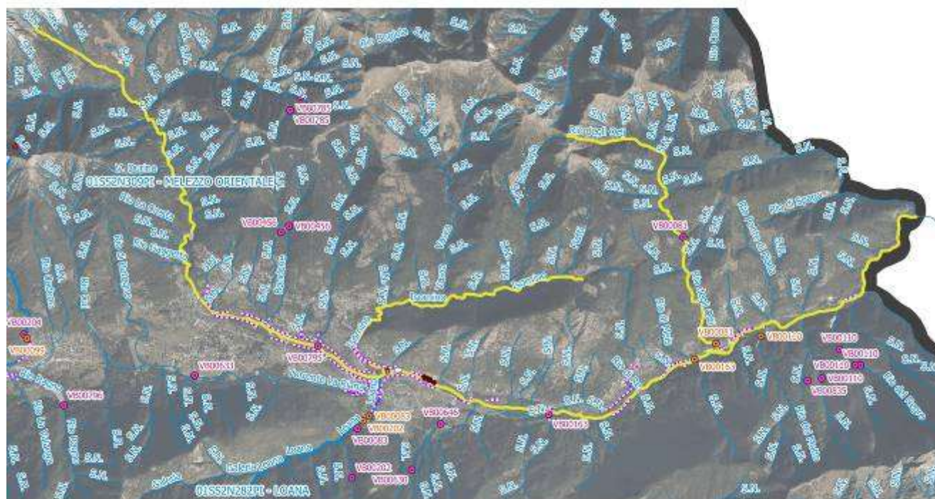
Figura 1. Corpo idrico Melezzo Orientale CI01SS2N309PI (evidenziato in giallo) e derivazioni idriche attive (captazioni di colore rosa e restituzioni di colore arancione).
