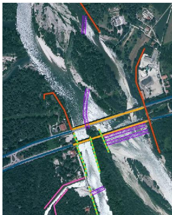
Soglia a protezione del ponte ferroviario.
