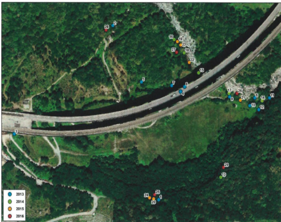
Fig. 2 – Localizzazione dei punti di monitoraggio geomorfologico rispetto all'area di cantiere (carta tratta dal documento di TELT "report annuale 2016 – suolo e geomorfologia" cod, MADMA3FEN0286APANOT)
