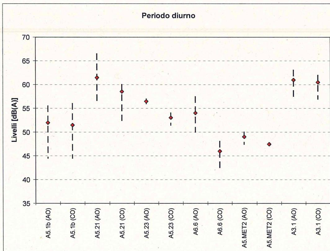
*Livelli assoluti di immissione diurni riscontrati durante i rilievi AO e CO (i punti rossi indicano i valori medi e le linee tratteggiate indicano la dispersione dei dati rilevati)*
