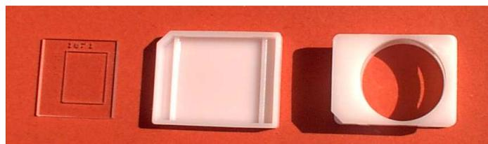
Figura 1: immagine di un dosimetro passivo a tracce: sono visibili il telaio del dosimetro (plastica bianca conduttiva) e la parte sensibile alle radiazioni, il rivelatore CR39 (plastica trasparente).
